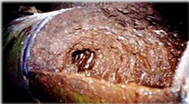
Загрязненная труба в поперечном сечении 90%
