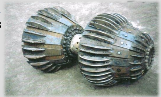
Гидродинамический кавитационный генератор HGK 700 для диаметра трубопровода 700 мм.
