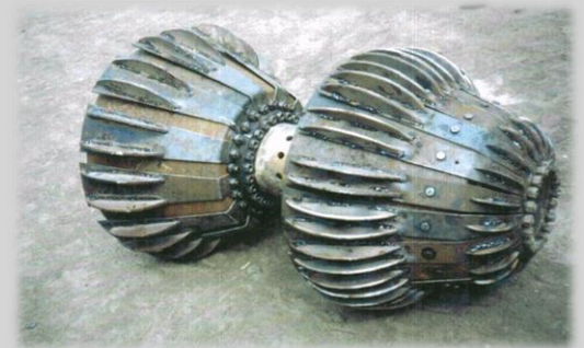
Hydrodynamiczny generator kawitacyjny HGK 700 dla średnicy rurociągu 700 mm.
