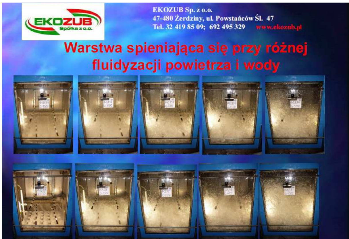
Slajd 1. Stanowisko badawcze do określenia zależności strumienia gazu zanieczyszczonego do ilości podawanej wody z uwzględnieniem wymaganej skuteczności.
