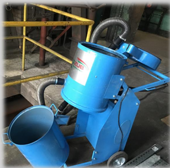
Odkurzanie kotłowni węglowej z pyłu węglowego i popiołów
